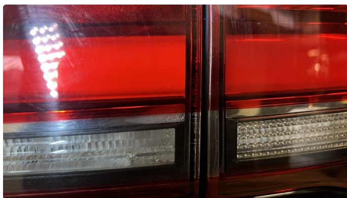
2.1 Krakelering i plast - 21.11.25 EK - Blir byttet med ny som hadde stor sprekk. Andre har kun liten krakkelering og ingen lekkasje.
