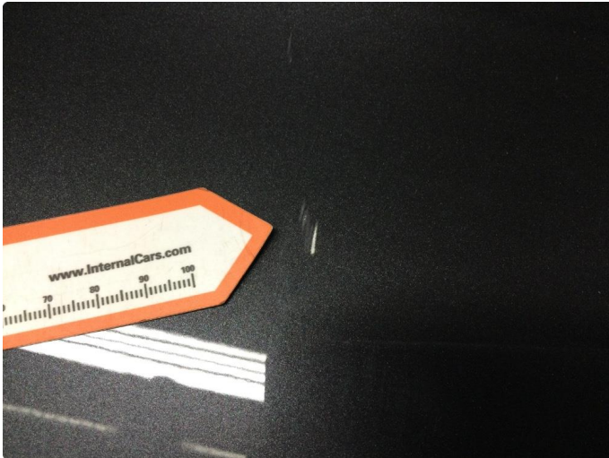
1.1 Liten lakkskade - 21.11.25 EK - Utbedret med lakkestift
