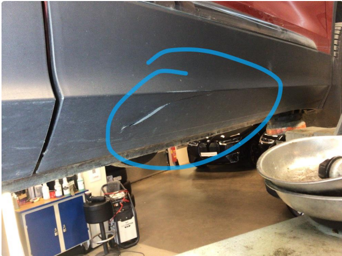
1.1 Bulker HFD + skade plast deksel HFD+ overflate små riper
