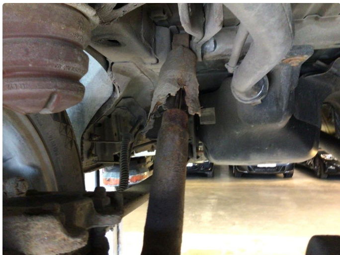
1.1 Støtdemper beskyttelse bak rust
