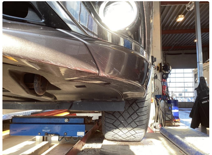
1.2 Riper i nedre del støtfanger foran. Lakkskade nedre del støtfanger bak.
