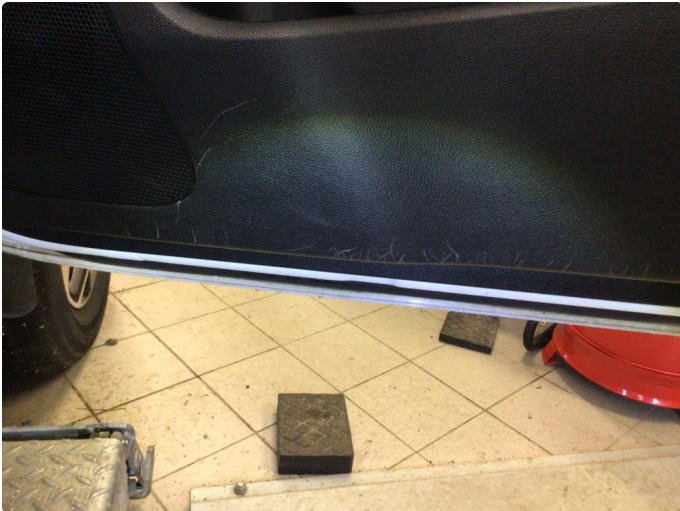
1.1 Skadet/merker etter utstyr
