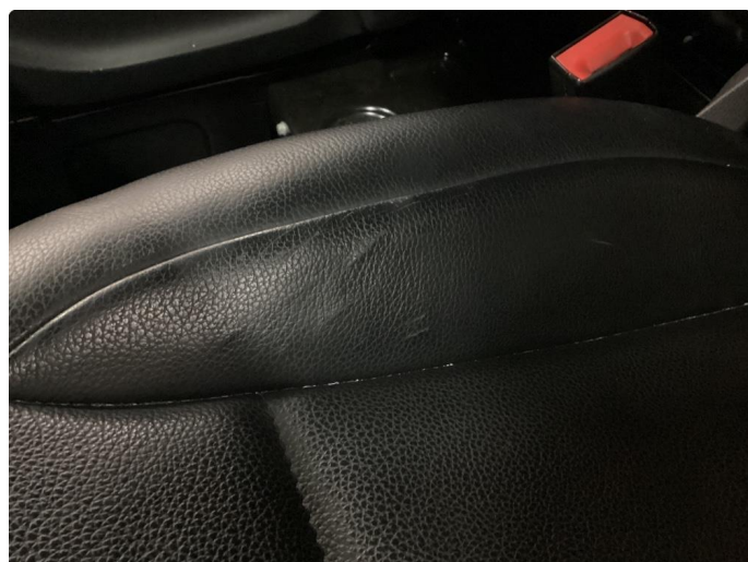
2.1 Skade på setetrekk
