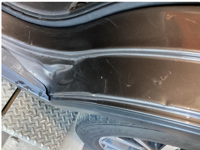
1.3 Noen riper og småbulker
