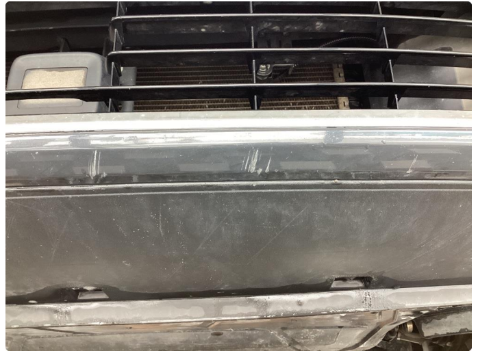
1.2 Noen riper under støtfanger foran
