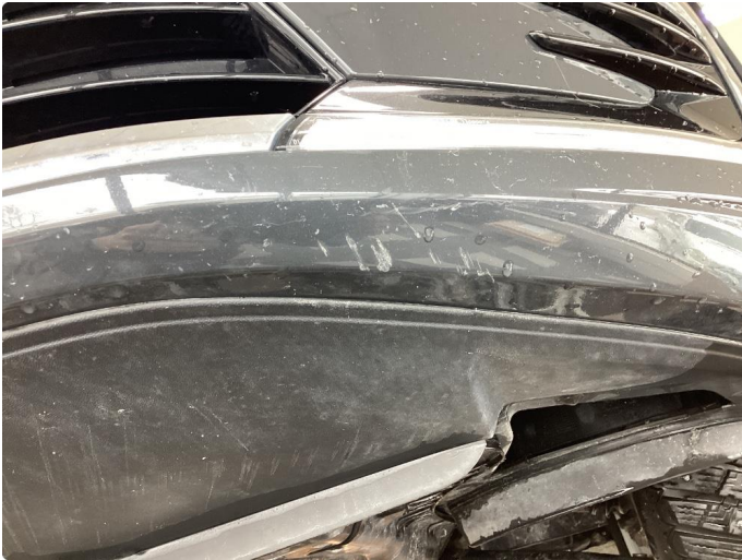
1.2 Noen riper under støtfanger foran
