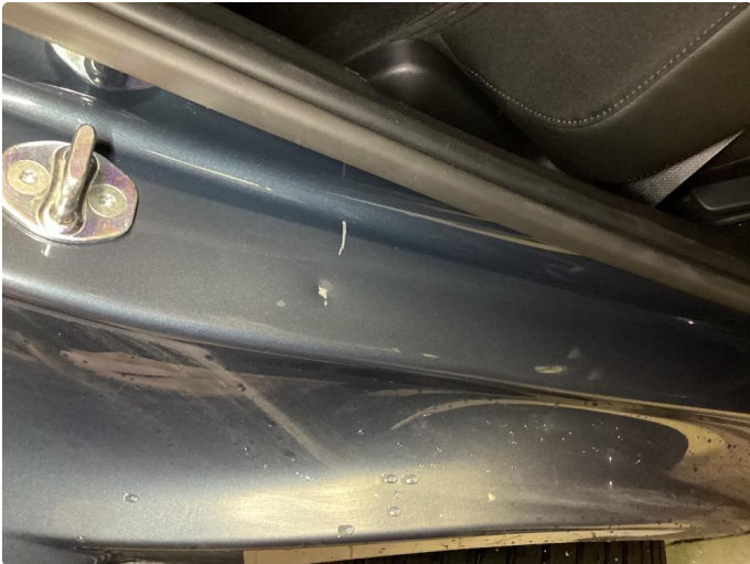
1.2 Bulk(er) med lakkskade
