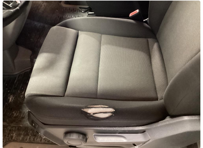
2.1 Skade på setetrekk
