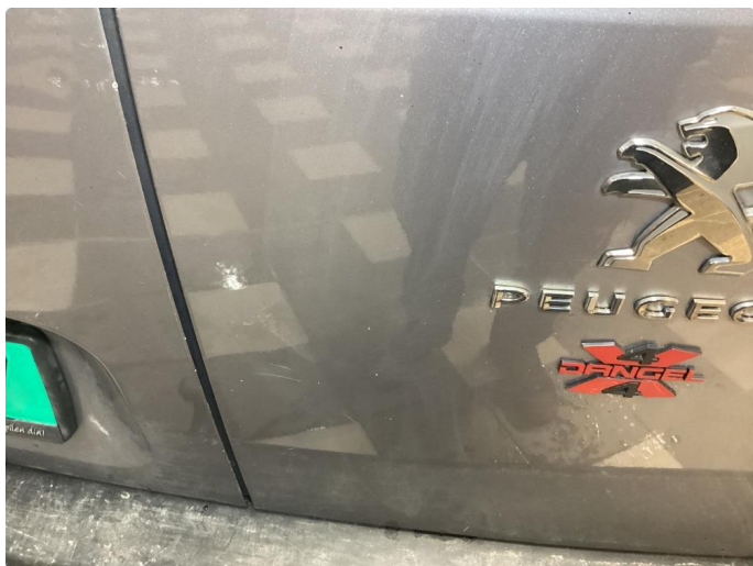
1.3 Steinsprut høyreside og bak etter vind
