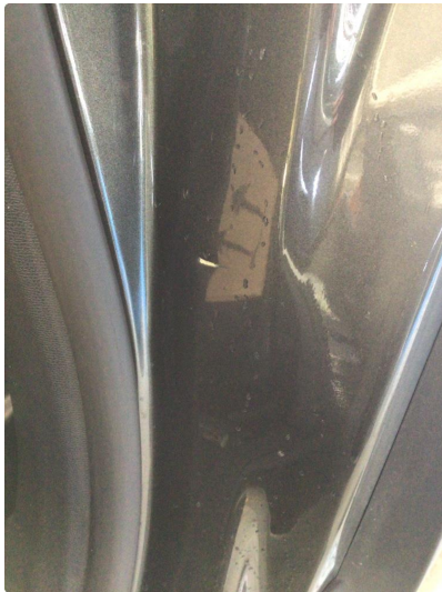
1.1 Noen riper og småbulker
