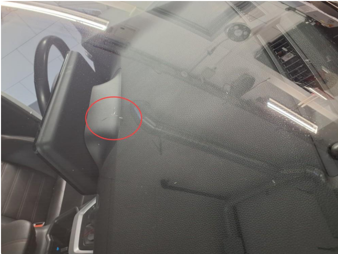
1.3 Steinsprut med sprekk. Blir byttet.
