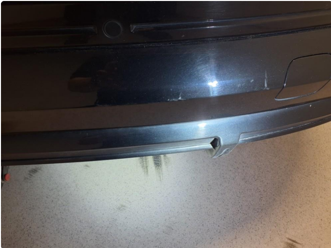
1.1 Ripe(r) ned til grunning
