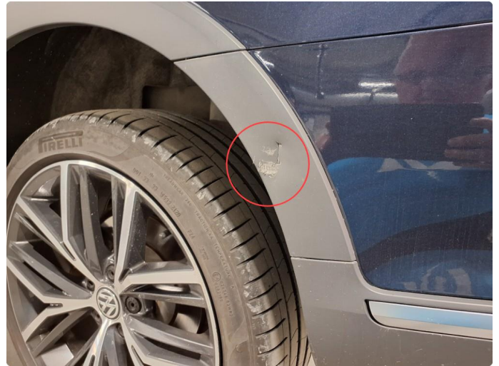
1.4 Lister skadet/mangler. Byttes ved service i Desember.
