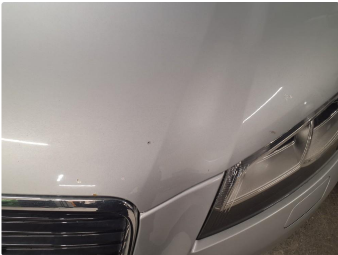
1.1 Noe steinsprut med rust
