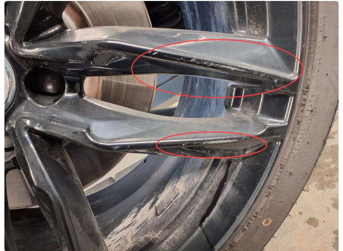
1.2 Skade på felg
