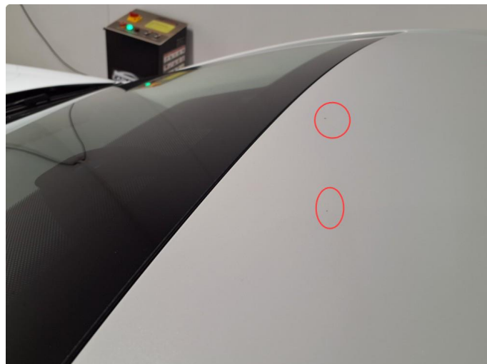
1.2 Steinsprut med rust på tak
