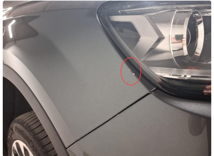
1.2 Noe steinsprut skjermer foran
