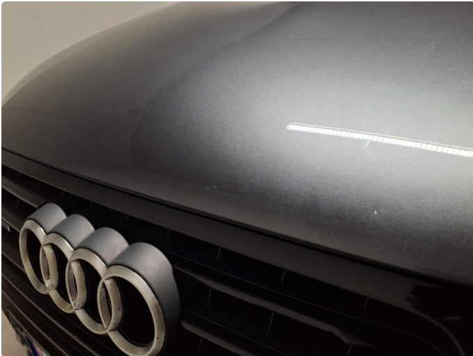
1.1 Noe steinsprut panser
