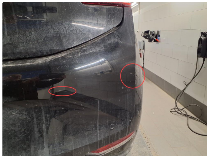
1.4 Ripe(r) ned til grunning
