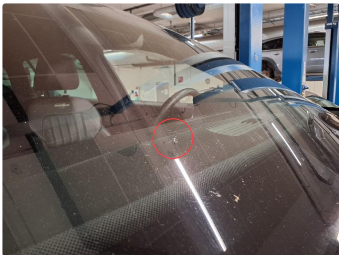
1.7 Steinsprut med sprekk
