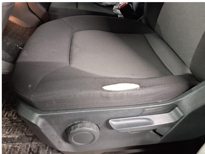
2.1 Skade på setetrekk. Blir utbedret.
