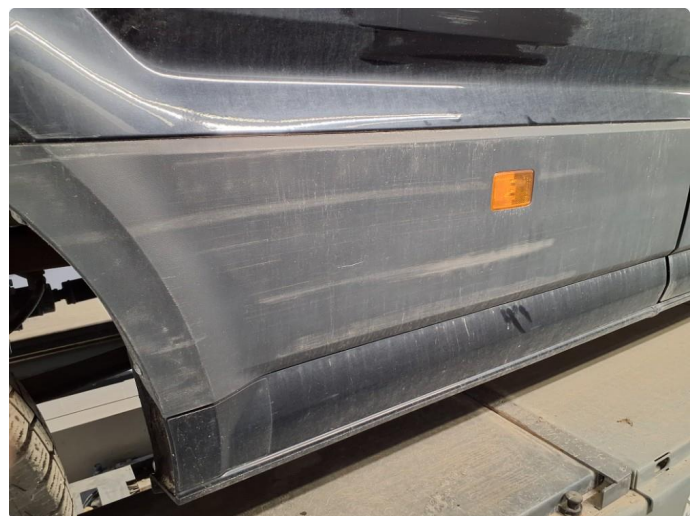
1.3 List mangler/skadet. Blir utbedret.
