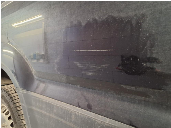
1.2 Ripe(r) ned til grunning. Blir utbedret.
