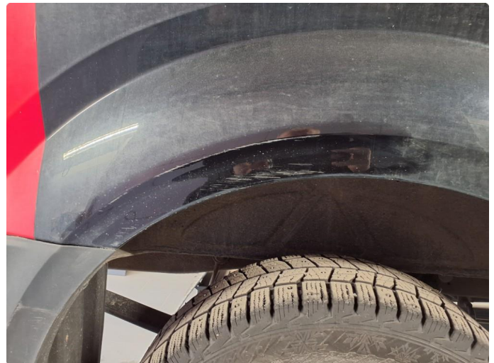
1.2 Ripe(r) ned til grunning. Blir utbedret.
