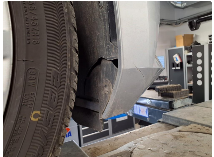
1.4 Plastinnerskjerm skadet. Blir reparert på Bilbyen Skadesenter.
