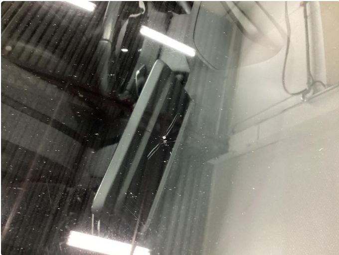
1.1 Steinsprut med sprekk
