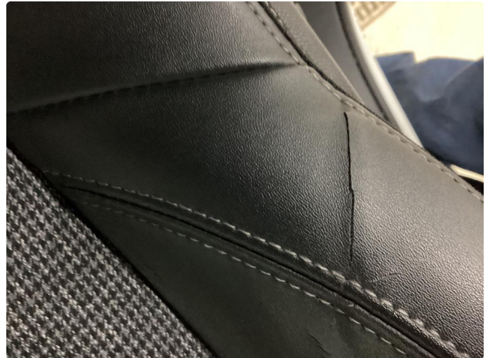
2.1 Skade på setetrekk
