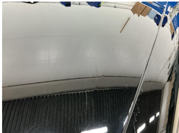
1.2 Ripe(r) ned til grunning
