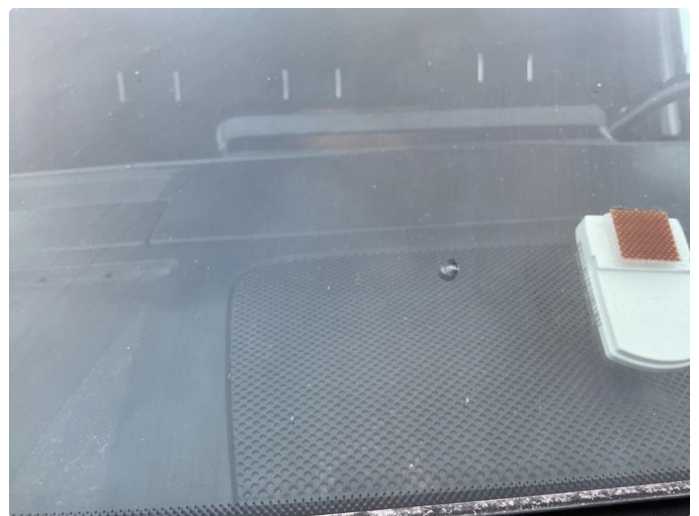
1.5 Steinsprut med sprekk
