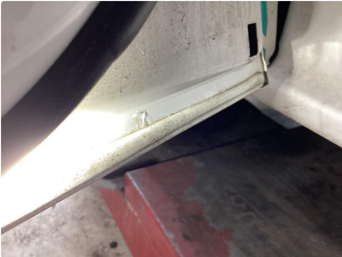
1.1 Rust i fals
