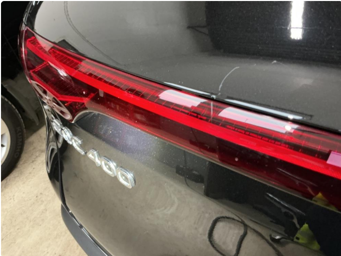
1.1 Ripe(r) ned til grunning
