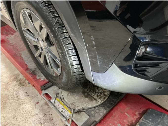
1.1 Ripe(r) ned til grunning
