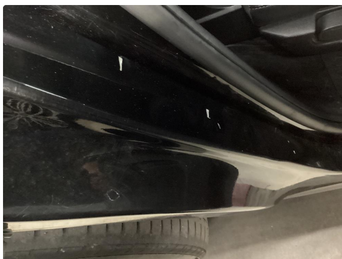
1.4 Bulk(er) med lakkskade
