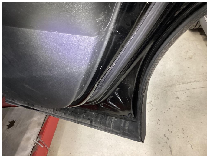
1.4 Bulk(er) med lakkskade
