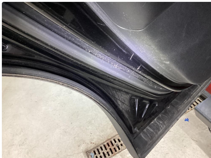
1.4 Bulk(er) med lakkskade
