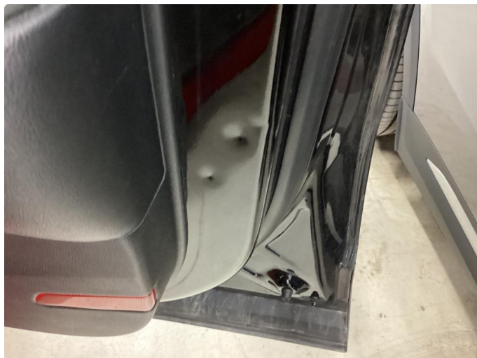
1.4 Bulk(er) med lakkskade
