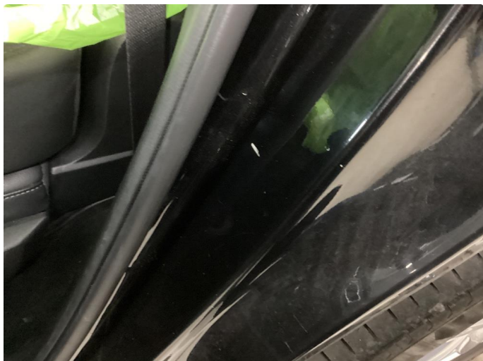
1.4 Bulk(er) med lakkskade
