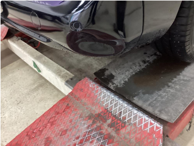
1.1 Bulk med lakkskade
