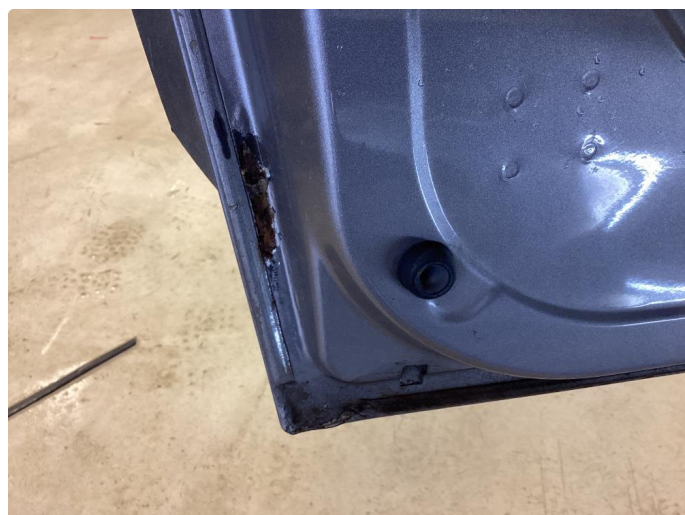
1.3 Rust i fals (ingen garanti på bilen)
