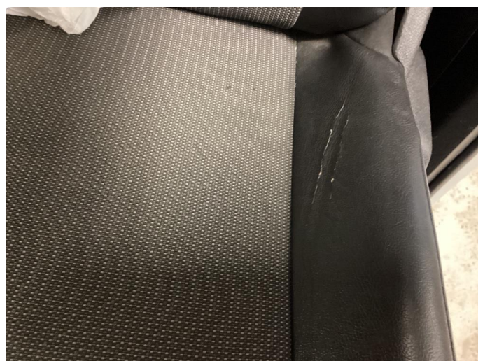
2.1 Skade på setetrekk
