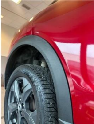
1.1 Litt oppripet på skjermutbygger høyre bak
