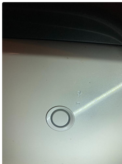
1.2 Noen steinsprut i fanger foran. Normal slitasje
