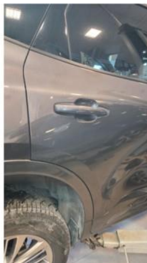
1.2 Riper på høyre bakdør, håndtak og hjulbue
