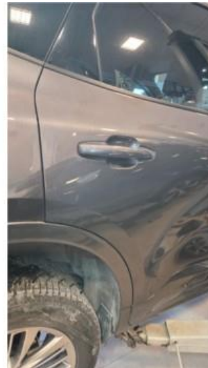
1.2 Riper på høyre bakdør, håndtak og hjulbue
