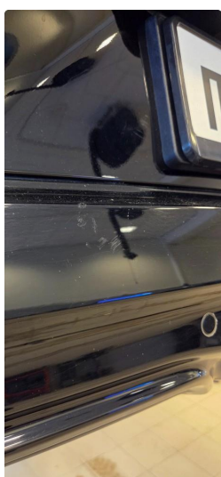
1.4 Små riper på støtfanger bak
