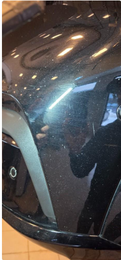
1.1 Små riper på støtfanger bak
