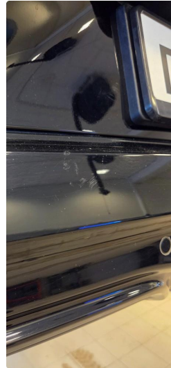
1.1 Små riper på støtfanger bak
