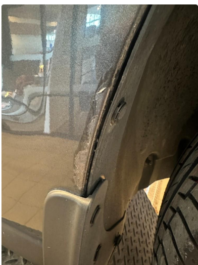
1.5 Noe rust på begge skjermer foran
