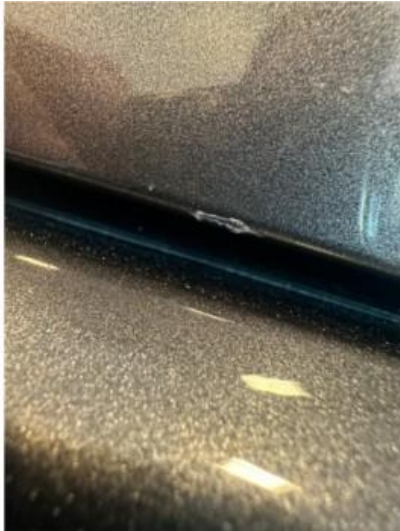
1.1 To små lakkskader bak
