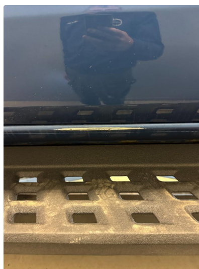
1.2 Noe slitt lakk i terskler/innlastningsone venstre foran
