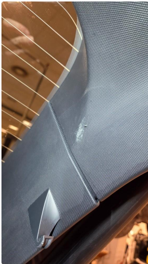
2.1 Noen riper på deksel, innside av bakluke
