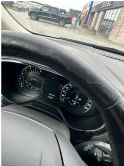
2.1 Slitasje på ratt
