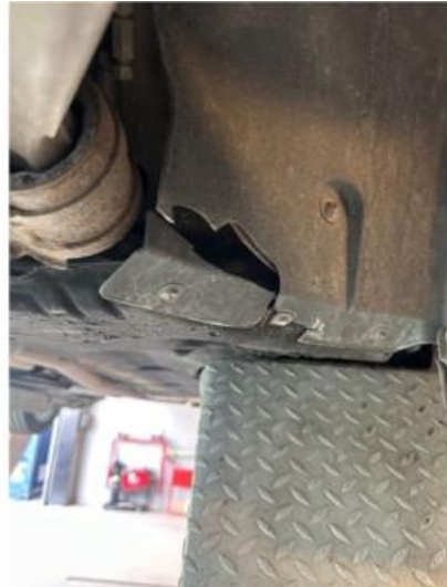
1.3 Skade på plastinnerskjerm venstre side foran
