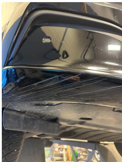
1.2 Noe oppripet på underside av fanger foran
