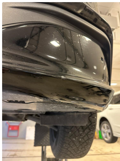
1.2 Noe oppripet på underside av fanger foran
