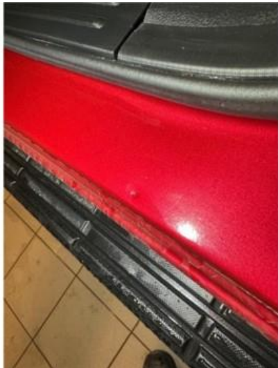
1.1 Liten bulk i døråpning venstre bak
