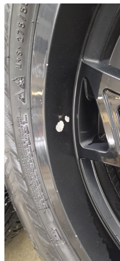
1.2 Liten felgskade gjennom lakk, flekkes
