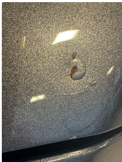
1.2 Liten bulk med lakkskade i panser høyre foran. Lakkeres forenklet
