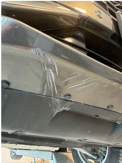
1.2 Noe oppripet på underside av fanger foran
