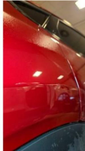
1.1 To riper på bakskjerm og bakfanger høyre side
